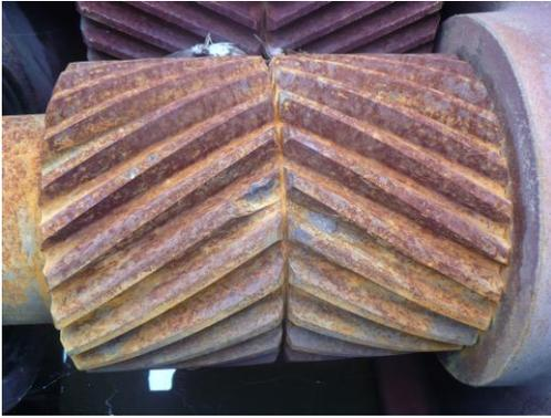
Figura 12. Piñón cilíndrico con dientes bihelicoidales.
